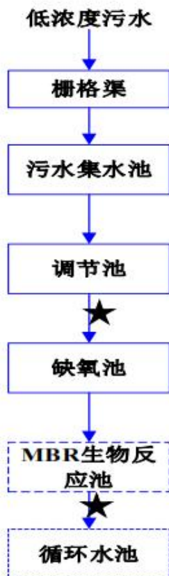
图 8.2-4 焚烧厂低浓度废水处理工艺流程图
