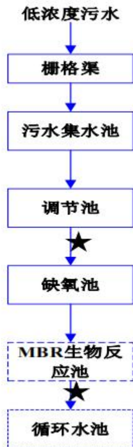
图 8.2-2 焚烧厂低浓度废水处理工艺流程图
