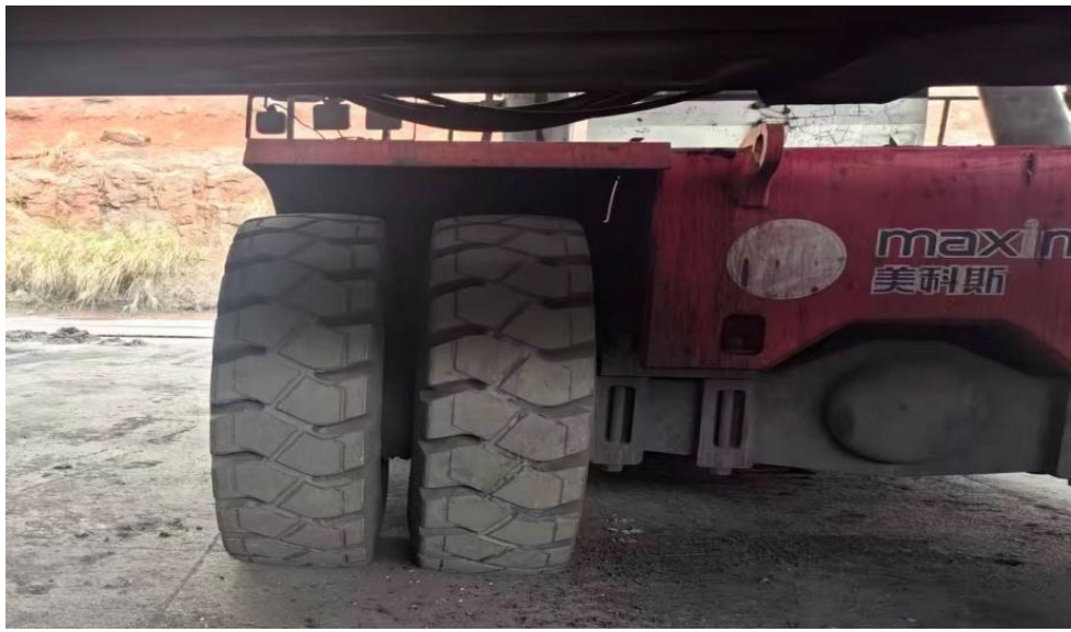
图2 涉事正面吊右前侧原轮胎图
